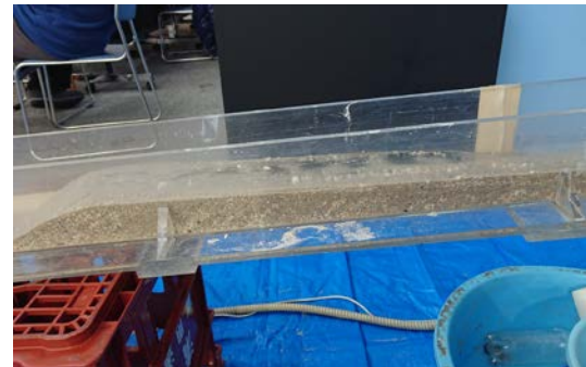
海水準変動を再現させてできる地層の ダウンラップ構造 (目代邦康講師)
